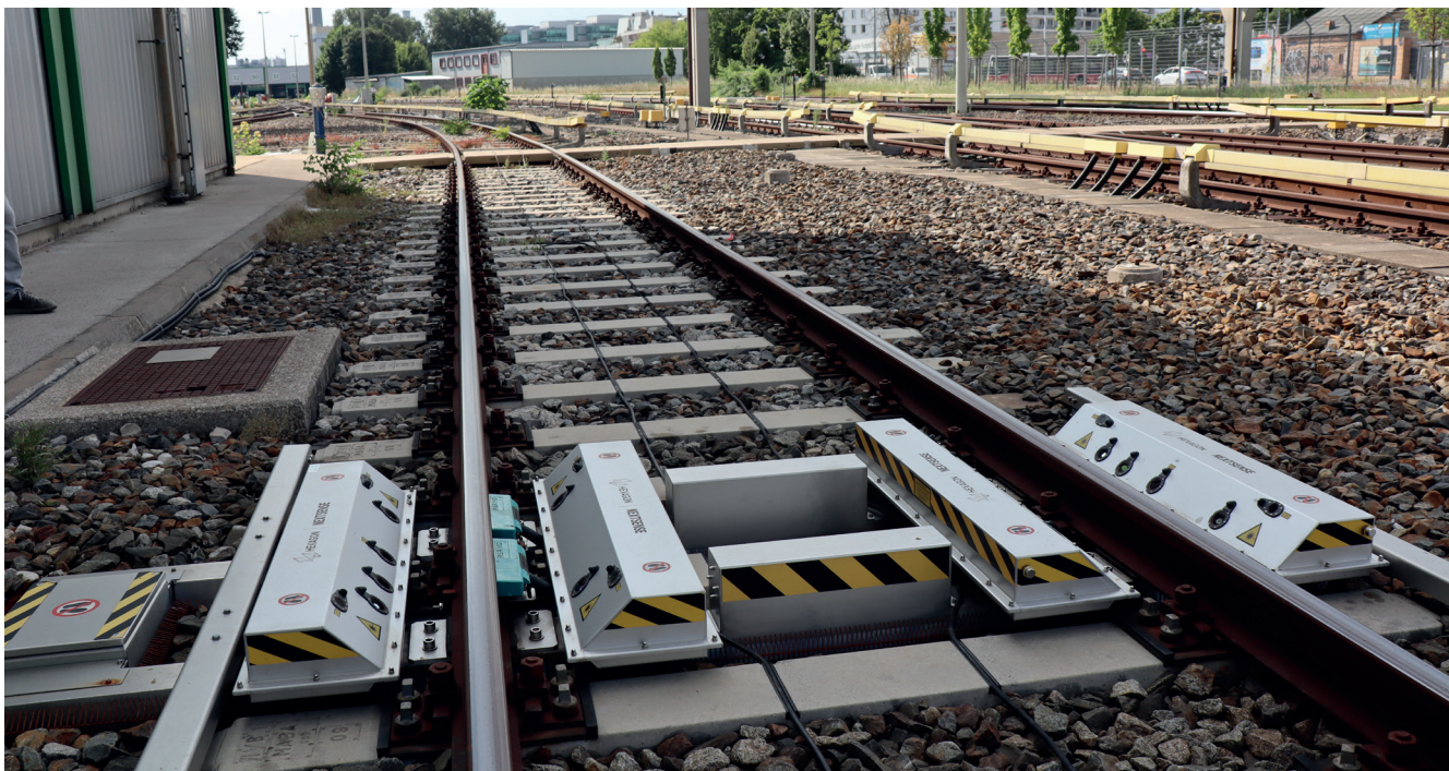
Das Messgerät CALIPRI X wird direkt im Gleisbett installiert, entweder vor Depots, Werkstätten, Waschanlagen oder an Anschlussgleisen. So können häufige Messungen ohne zusätzlichen Aufwand und Kosten durchgeführt werden. Hier ist es bei den Wiener Linien in Wien Erdberg installiert.
